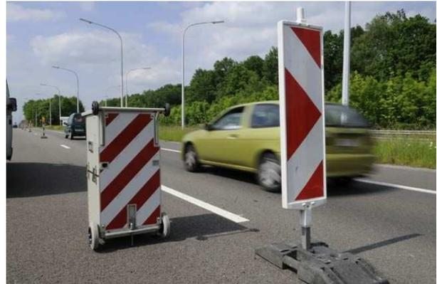
Une nouvelle catégorie de « radars » automatiques est disponible sur le marché, avec la particularité de pouvoir répondre au besoin spécifique des zones de chantiers. Il s'agit des radars semi-fixes.
